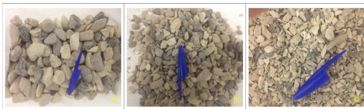
Figura 1: Agregados de seixo rolado de calcário: brita 0 (a), brita 1 (b), areia Remblais (c)
